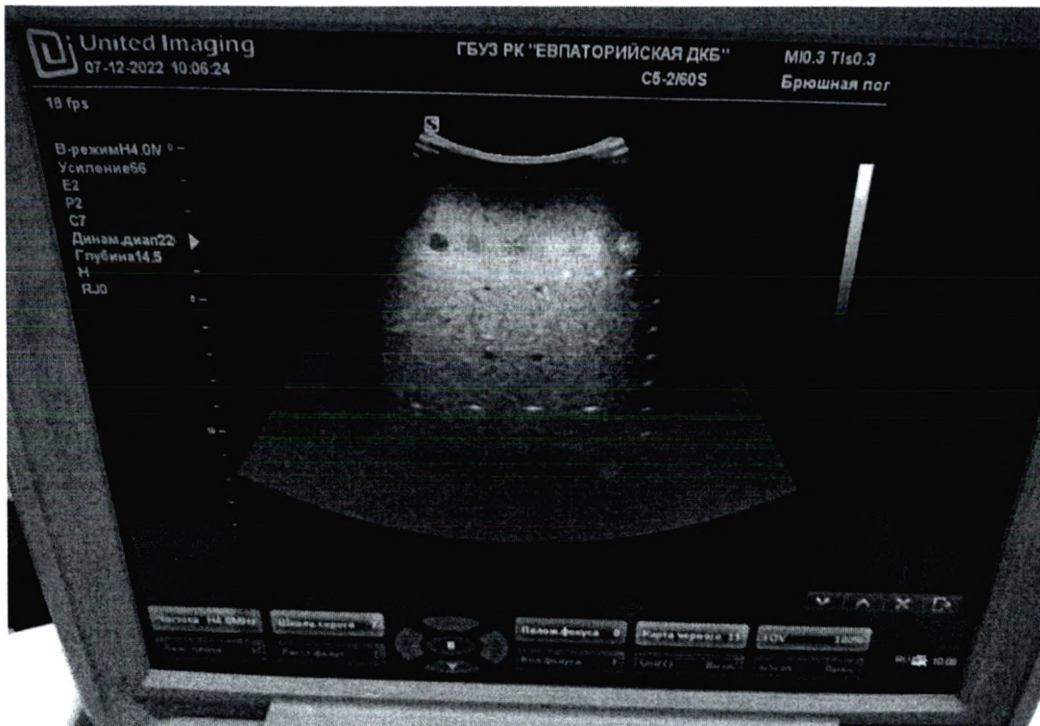
УЗ отображение тест-объектов фантома УЗИ датчиком С5-2/60S
