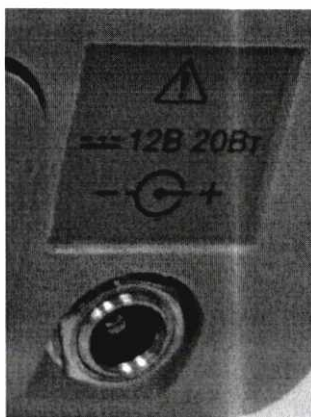
Фотографическое изображение 9 - Ввод для подключения источника постоянного тока
