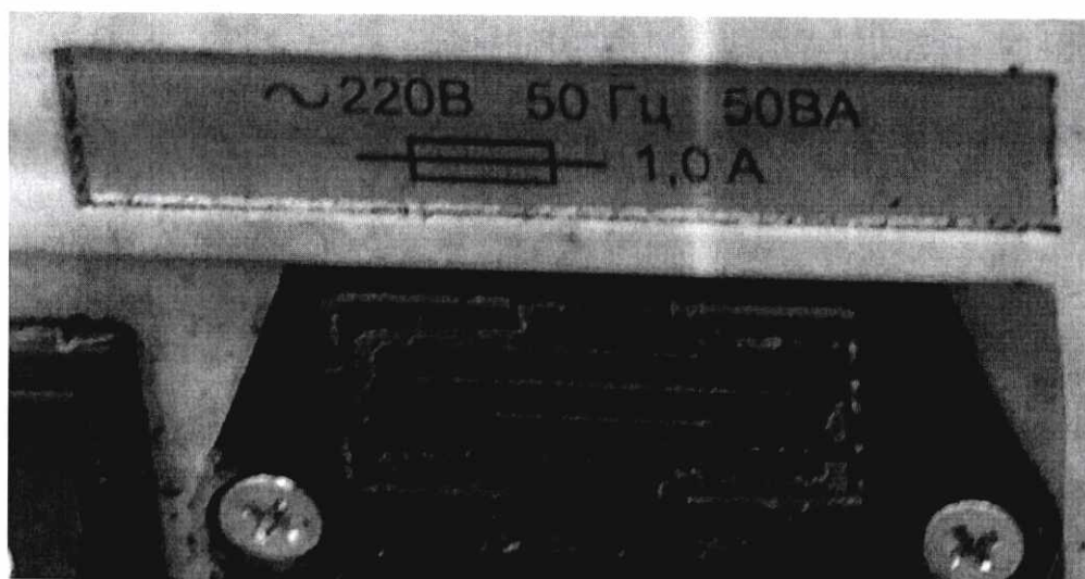
Фотографическое изображение 7 – Маркировка держателей предохранителей
